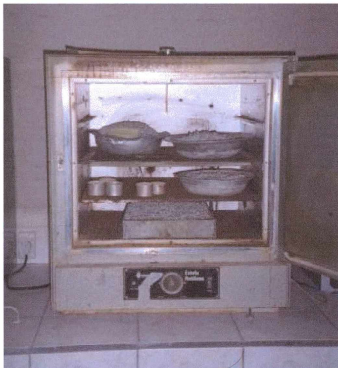
Figura 5.2: Secagem dos agregados na estufa
