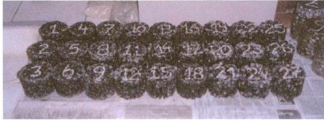
Figura 5.24: Corpos de prova Marshall da segunda etapa
