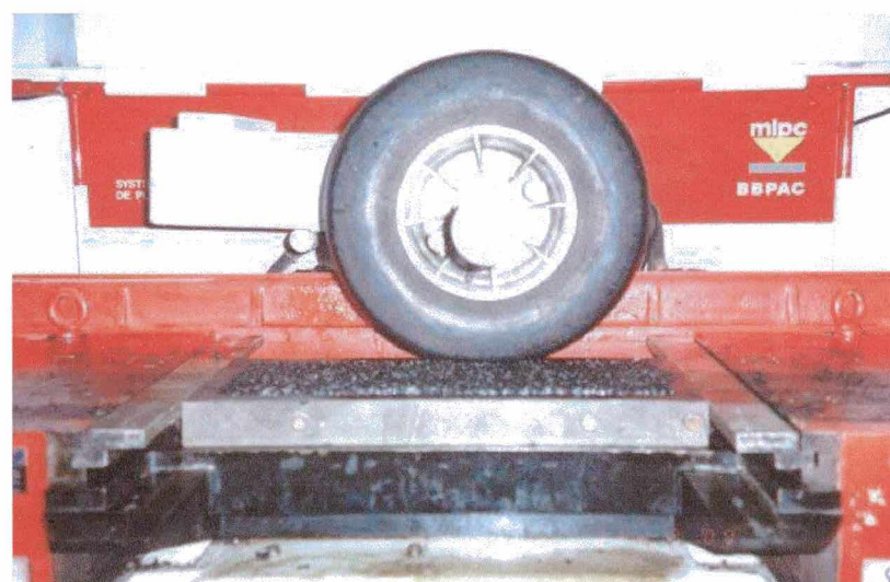
Figura 5.34: Compactação da placa (AFNOR NF P 98-250-2, 1993)
