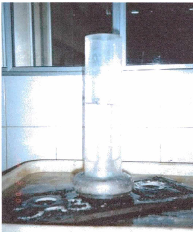
Figura 5.35: Ensaio de permeabilidade
