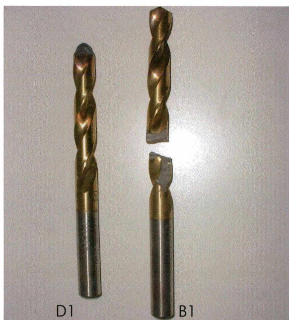
FIGURA 58 – Estado final das brocas D1 e B1 após o colapso.
