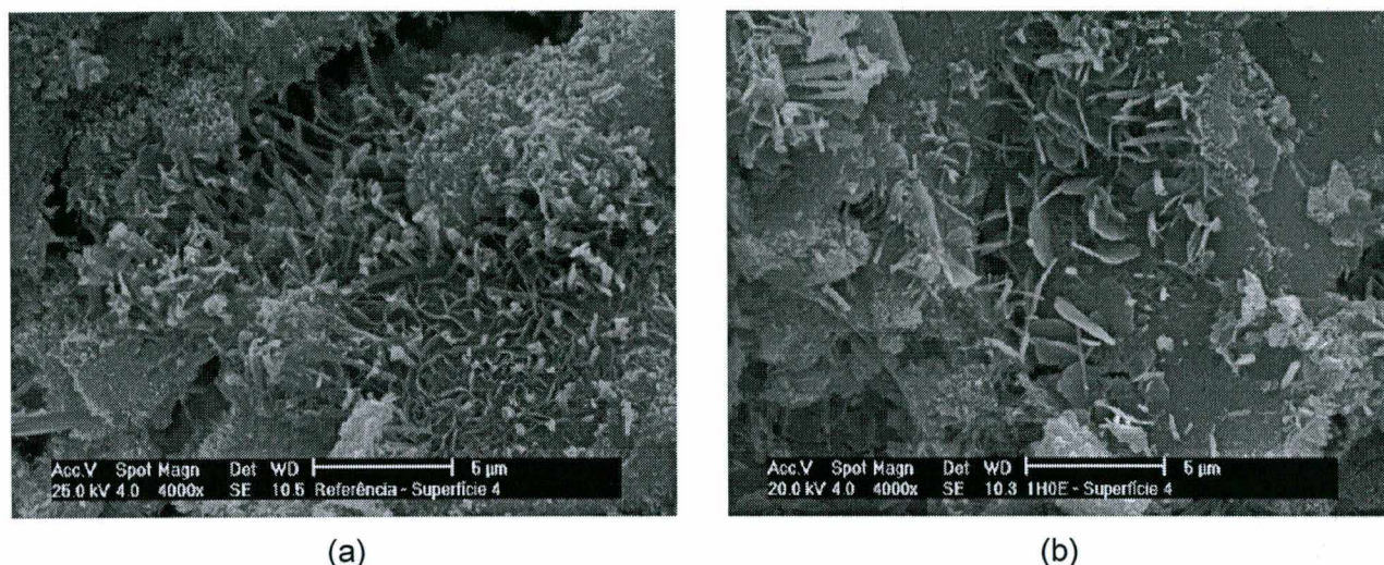
Figura 6.31– Cristais de etringita e monosulfoaluminato na pasta pura (a) e em pasta com 1% de HEC (b).
