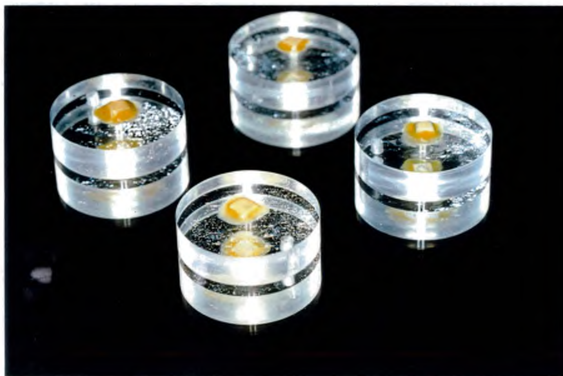
Figura 4 - Blocos que receberam a aplicação tópica de diaminofluoreto de prata, prontos para a última análise de microdureza superficial.
