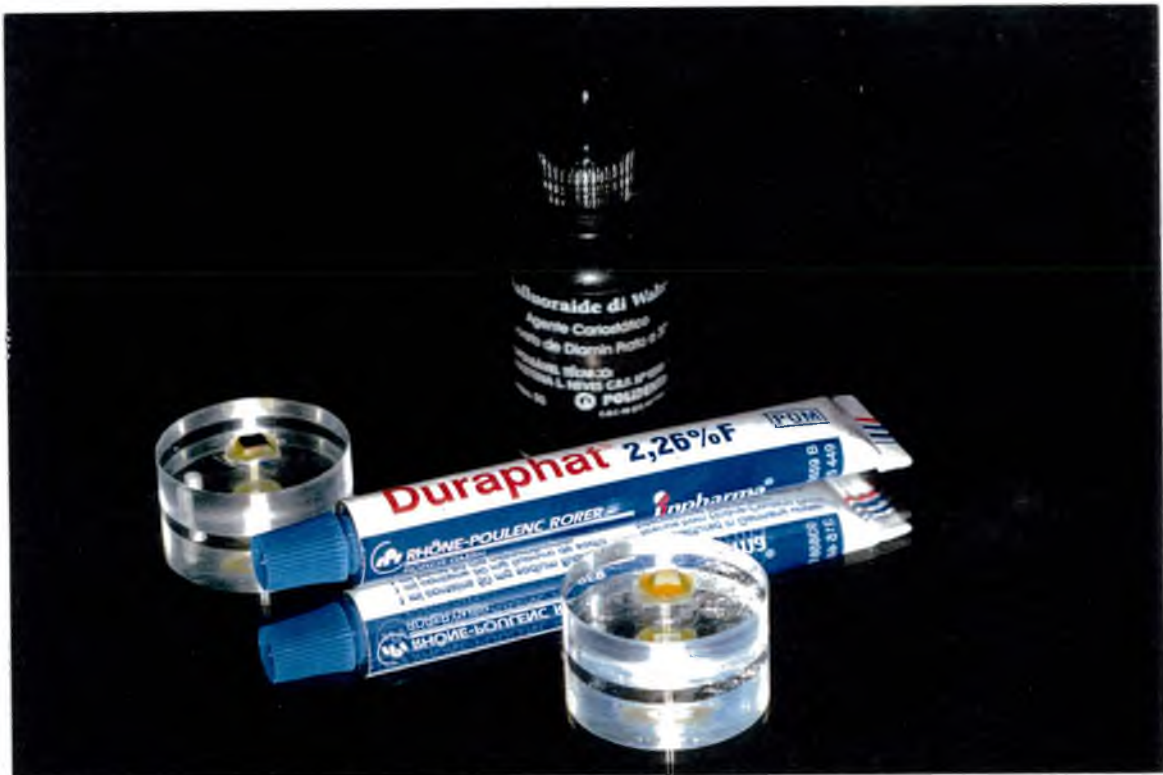
Figura 3 - Blocos de dentina bovina após a aplicação tópica de diaminofluoreto de prata e de verniz fluoretado.
