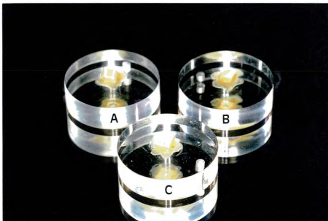
Figura 1 - Blocos de dentina bovina em diferentes níveis de preparação: A - vista da superfície interna pronta para o seu ajuste, B - vista da superfície interna após o seu ajuste e C - vista da superfície externa após o lixamento, biselamento e polimento.
