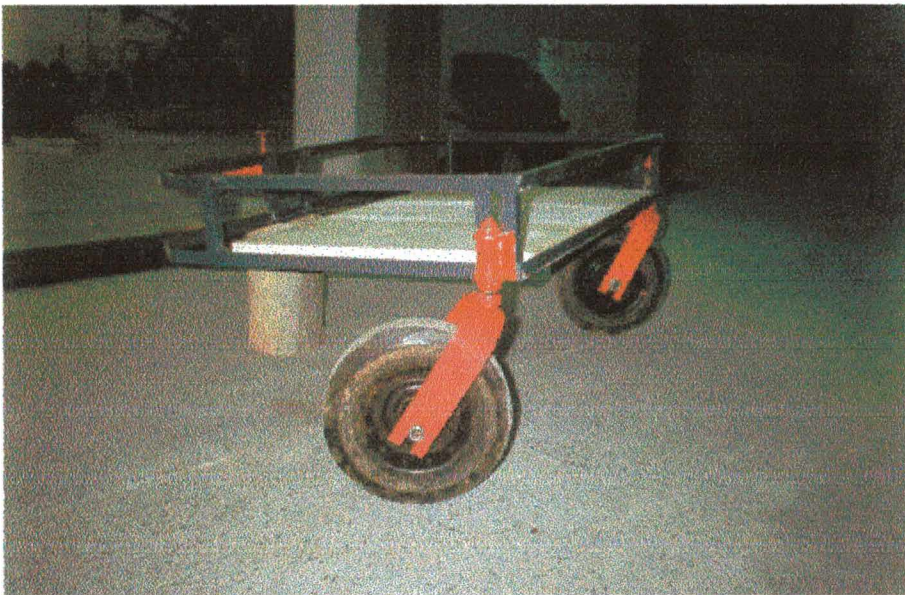
Figura 5.15: Pré-protótipo para testes de manobrabilidade do trator de rabiças.
