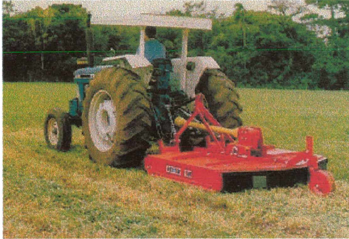
Figura 2.5: Modelo de roçadeira para tração tratorizada. (Fonte: Catálogo Jan).
