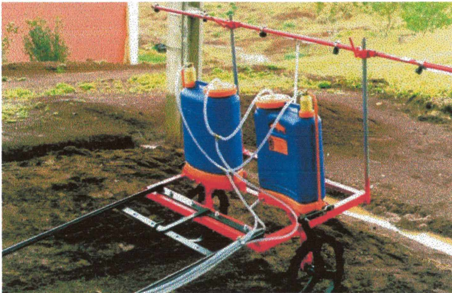
Figura 2.14: Adaptação feita com pulverizadores manuais. Santos (1997).
