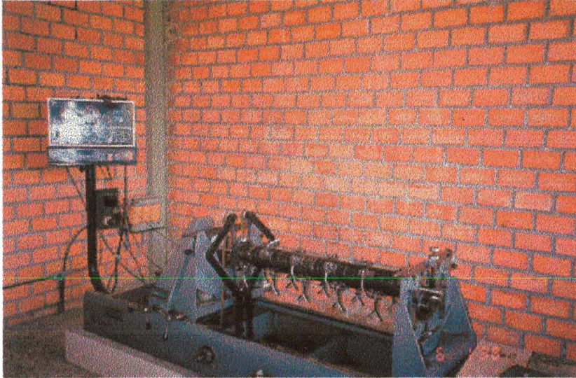
Figura 5.12: Máquina balanceadora Subra-Zanrosso (Gentileza Retífica Nereu - Palhoça, SC.)
