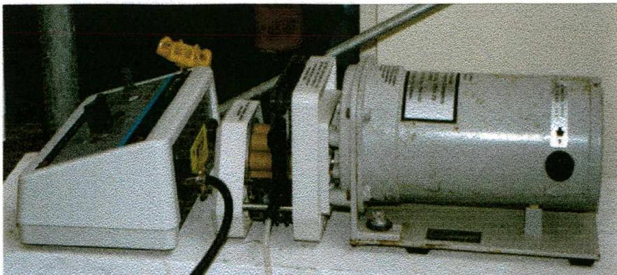
Figura 10: Bomba peristáltica para dosagem de sulfato de alumínio
