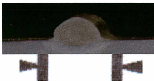
Figura 4.23 - Macrografia de depósitos produzidos com transferência por projeção axial e arco com comprimento visível de 5 mm. Dados: Ief: 175 A. (Distância entre setas: 10 mm).
