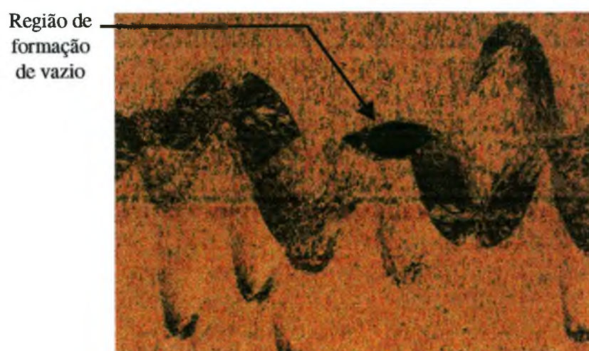
Figura A.16 - Micrografia de amostra retirada de peça injetada em poliacetal, com a condição C5, na qual há a formação de um vazio estrutural.
