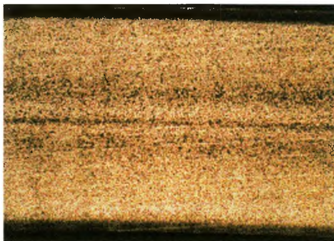
Figura A.14 - Micrografia de amostra retirada de peça injetada em polipropileno com a condição C4.
