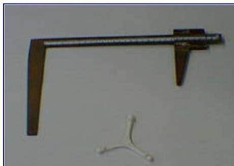
Figura 3.3: Medição da altura da cabeça    Figura 3.4: Medição do canal auditivo
