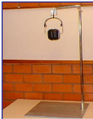
Primeiramente colocou-se o aparelho sobre um piso nivelado e através deste suspendeu-se o protetor auditivo pelo centro do arco tensor com as conchas voltadas para baixo, de modo que a altura do ponto mais baixo do protetor auditivo fosse de  $1,5\text{ m} \pm 1\text{ cm}$  acima da placa de aço. Logo após soltou-se o protetor auditivo sobre a placa de aço e, observou-se se houve a quebra ou soltura de alguma parte do protetor auditivo.
