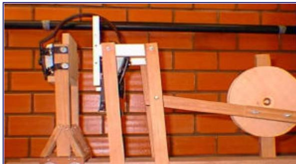
Figura 3.12: Aparelho de flexão do arco tensor
