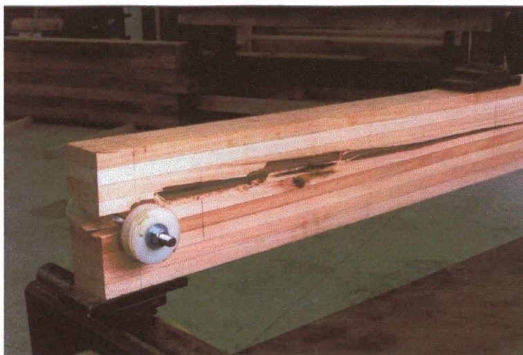
Figura 37 - Ruptura por cisalhamento na linha neutra
