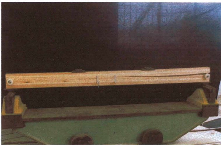
Figura 42 - Após o descarregamento a viga retorna a posição inicial
