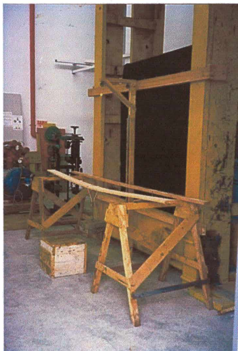
Figura 12 - Dispositivo utilizado p/ pré-classificação das lâminas
