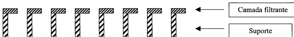
Figura 4 - Estrutura esquemática da membrana “composite”
