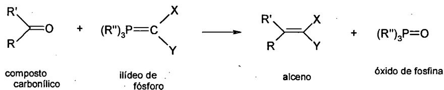
Esquema 2. Reação de Wittig na preparação de alcenos (25) .
