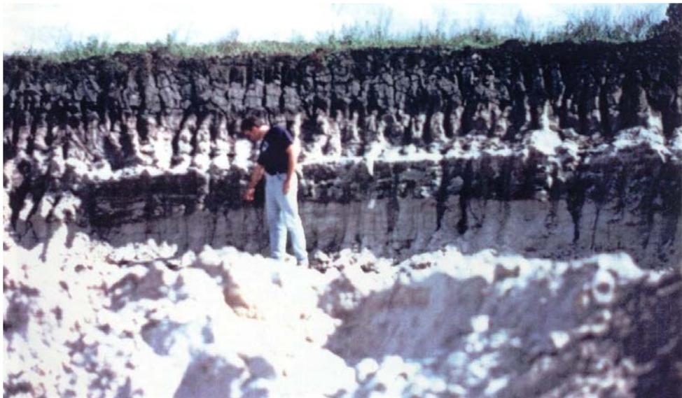
**Figura 23** – Solo hidromórfico, aluvião. Aspecto do contacto entre a areia (parte inferior) com argila cinza esbranquiçada caulinitica e argila orgânica negra. Rio Iguazu.
