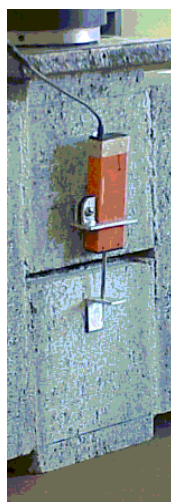
Figura 3.7 – LVDT fixado à quadripleta com o uso do suporte.
