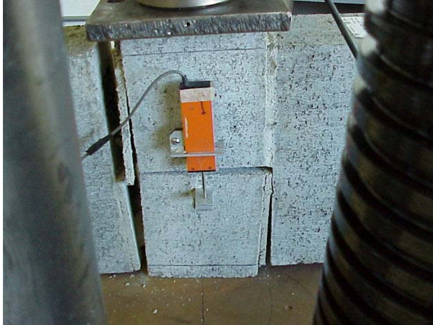
Figura 4.18 – Foto do ensaio de cisalhamento sem pré-compressão.
