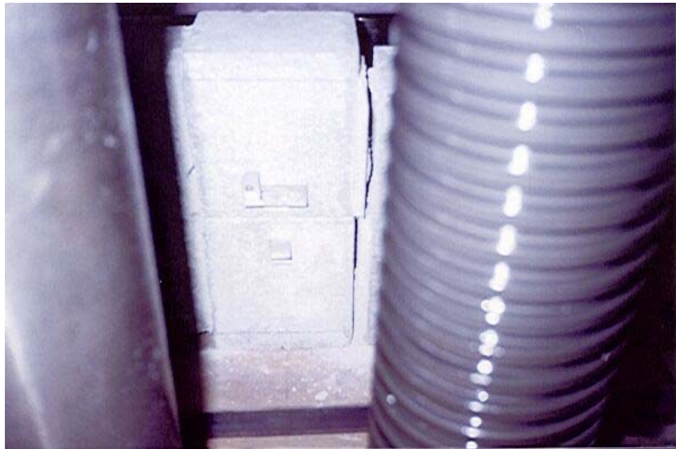
Figura 4.22 – Ruptura da quadripleta com 1,30 MPa de pré-compressão.
