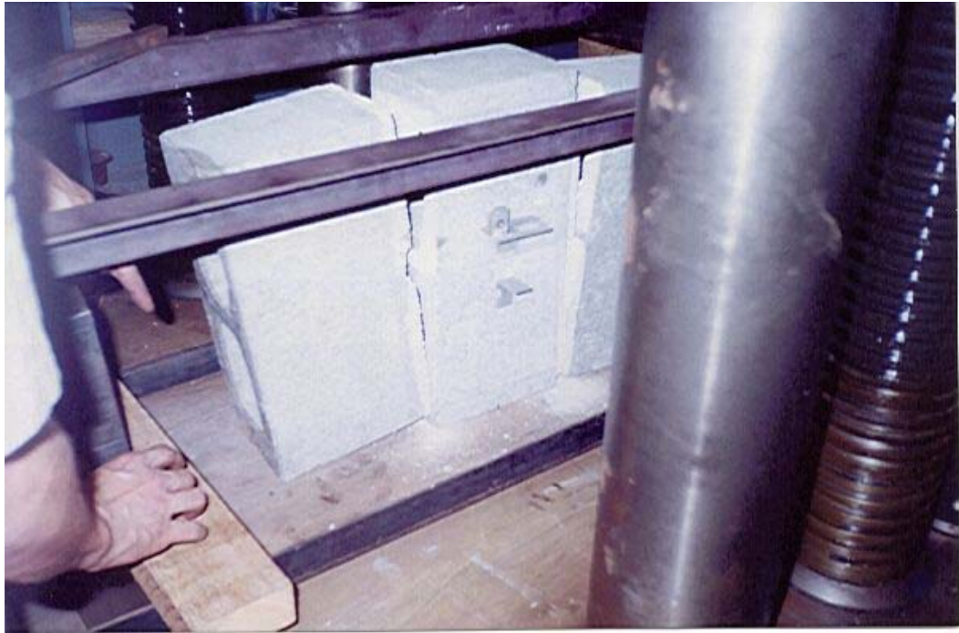
Figura 4.23 - Ruptura da quadripleta com 1,30 MPa de pré-compressão.
