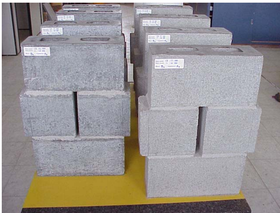
Figura 3.6 – Moldagem das quadripletas.
