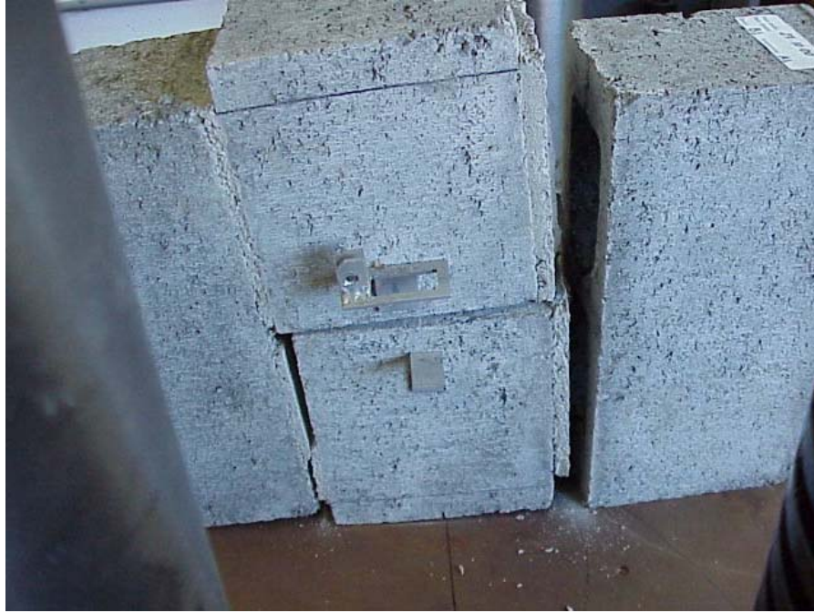
Figura 4.16 – Foto do ensaio de cisalhamento sem pré-compressão.
