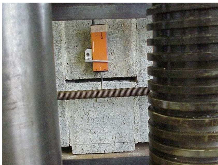
Figura 4.20 – Foto do ensaio de cisalhamento com pré-compressão de 1,30 MPa.
