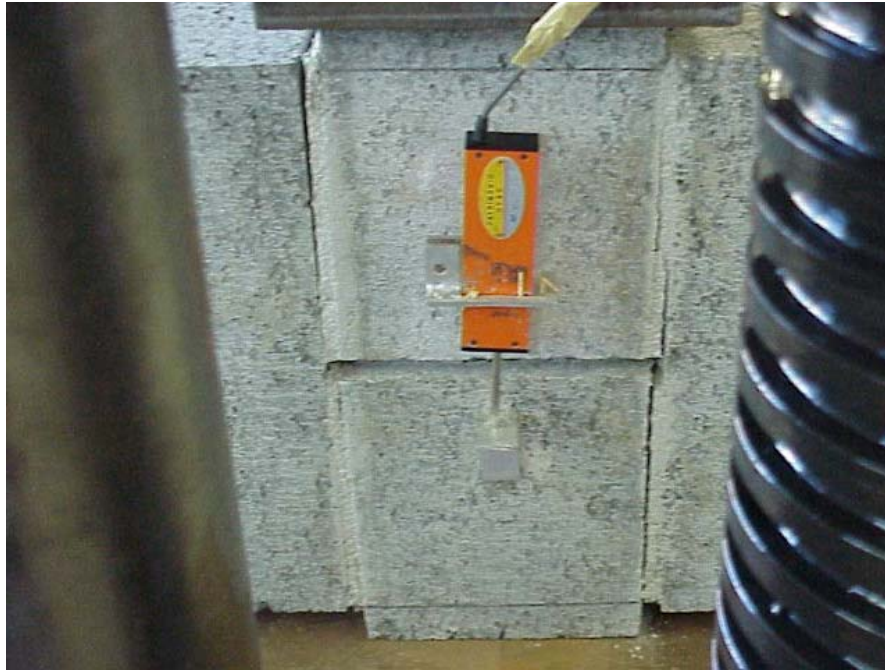
Figura 4.14– Foto do ensaio de cisalhamento sem pré-compressão.
