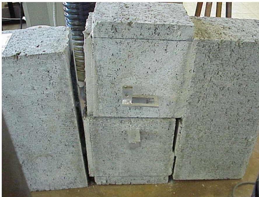
Figura 4.15 – Foto do ensaio de cisalhamento sem pré-compressão.
