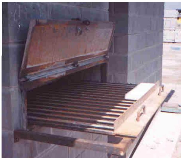
FIGURA 4.8: Detalhe da grelha deslizante.
