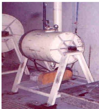
FIGURA 4.19: Moinho giratório usado na moagem das cinza “in natura” e modificada.
