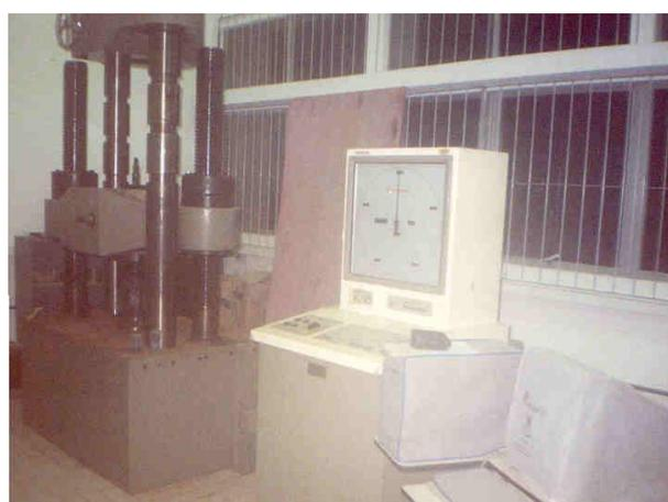
FIGURA 4.25: Prensa para realização do ensaio de resistência.
