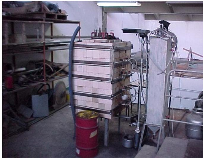
FIGURA 3.8: Fornalha protótipo desenvolvida por DAFICO (2001).
