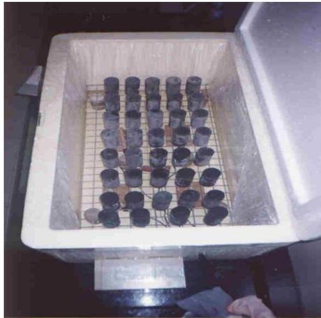
FIGURA 4.22: Cura térmica acelerada para o ensaio de pozolanicidade com cimento.
