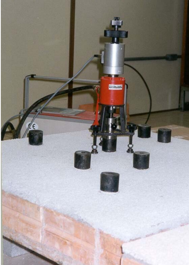
Figura 4.28 – Equipamento usado no ensaio de aderência
