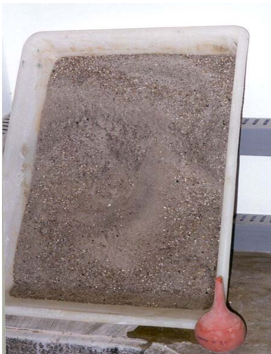
Figura 3.4 – Agregado sendo drenado
