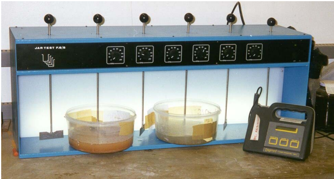
Figura 3.2 – Ensaio de Lixiviação – “jar-test” – Grupo Valores
