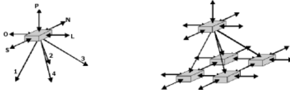
a) Topologia de um Elemento de Processamento. b) Exemplo de uma Pirâmide de 2 Níveis.
