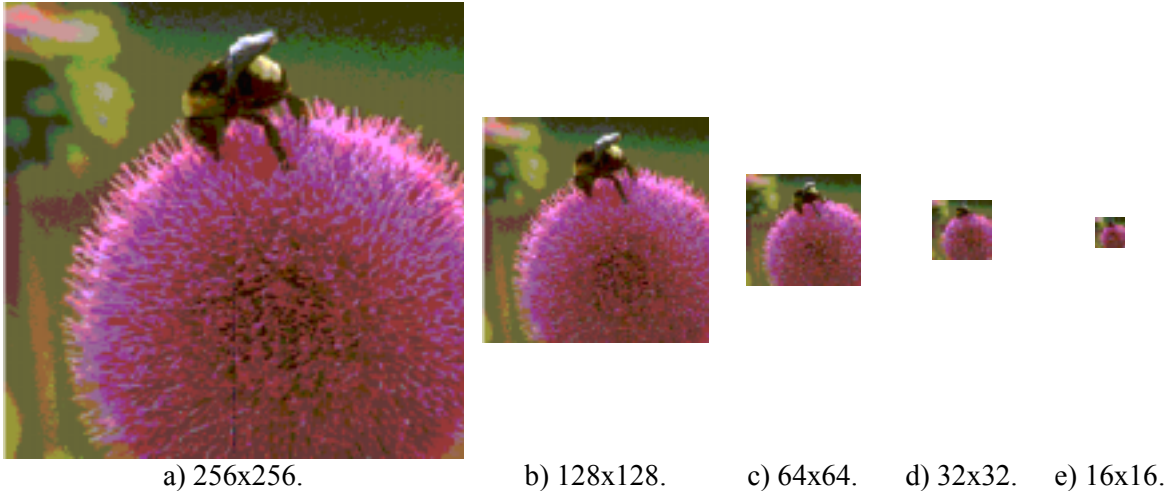
Fig. 4.3: Representação da Imagem por Pirâmides em Níveis de Resolução Diferentes.
