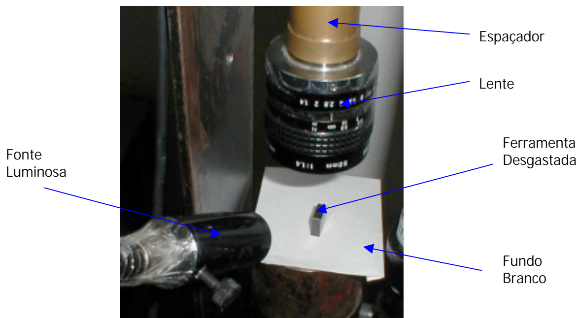
Fig. 7.1: Ilustração do Técnica de Iluminação Adotada.
