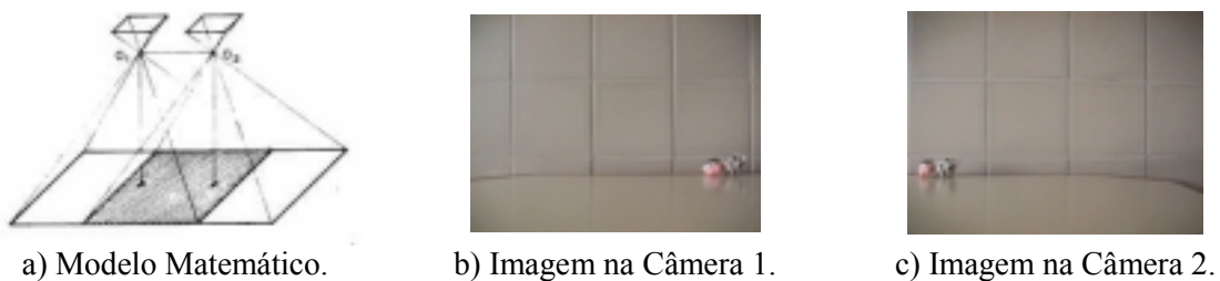
Fig. 8.3: Ilustração de um Sistema de Visão Utilizando Visão Estéreo [26].
