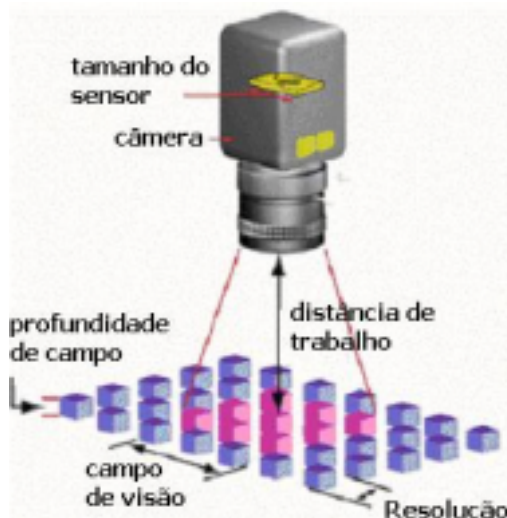
Fig. 3.2: Parâmetros Fundamentais em um Sistema de Visão [16].
