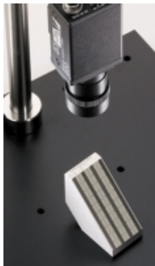
Fig. 3.1: Medição da Profundidade de Campo (Foco) [16].
