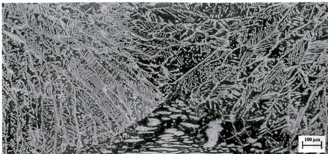
Figura 124 – Microestrutura mostrando o efeito da deposição de um segundo cordão adjacente ao primeiro cordão. Ataque: Beraha.
