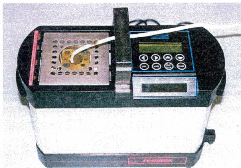
Figura 87 – Detalhe do bloco de calibração, modelo CL 750 da Ômega.
