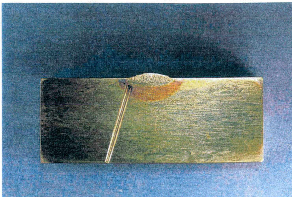
Figura 145 – Macrografia mostrando posicionamento do primeiro termopar na ZTA.
