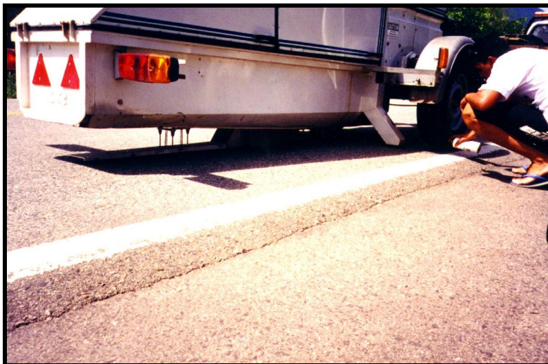
FIGURA 3.8 - Marcação com tinta spray na pista nas estação de ensaio
