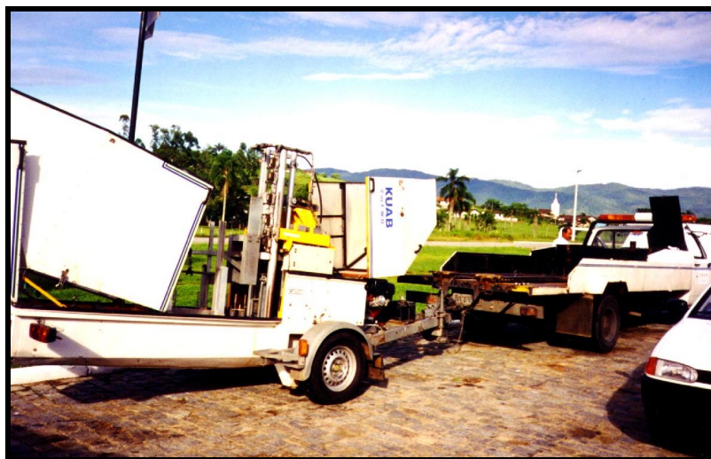
FIGURA 3.5 - Equipamento KUAB FWD de origem sueca
