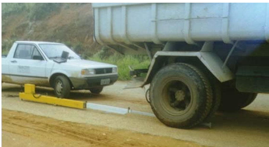
FIGURA 2.2 - Deflectógrafo Digital Solotest
