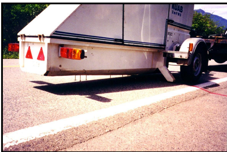
FIGURA 3.9 - Abaixamento da placa de carga e da barra com os sete sismômetros
