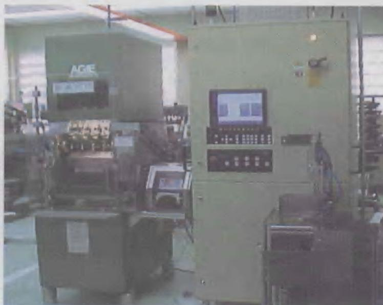
**Figura 4.2** - Máquina de eletroerosão por faíscas AGIE QUADRATON 1
