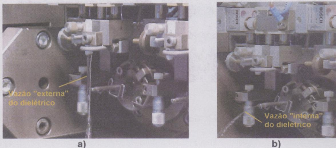
**Figura 4.7** - Visualização da vazão "externa" e "interna" do dielétrico
