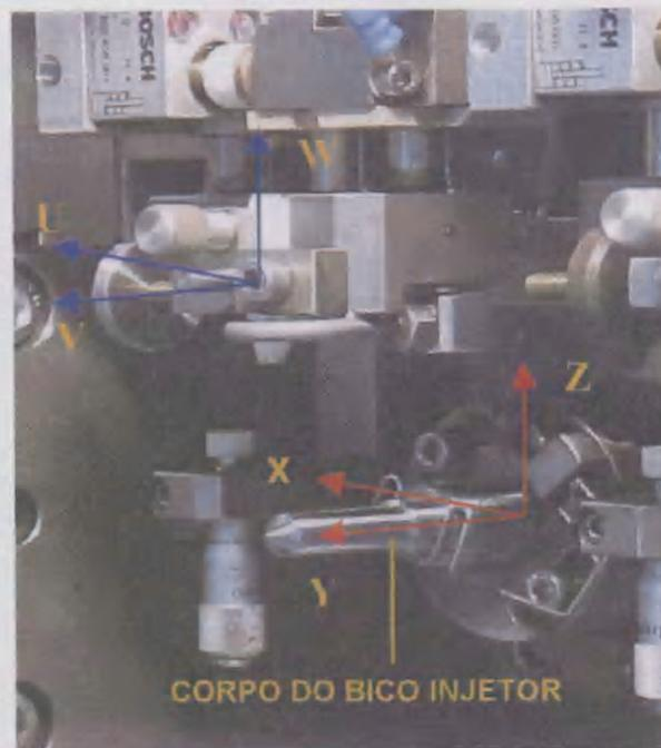
**Figura 3.9** - Eixos principais do cabeçote de uma máquina de eletroerosão por faíscas para bicos injetores (Máquina AGIE/CHARMILLES)
