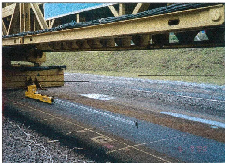
Figura 2.6 - Equipamento Deflectógrafo Digital – Solotest, sendo utilizado no simulador de tráfego DAER/UFRGS.
