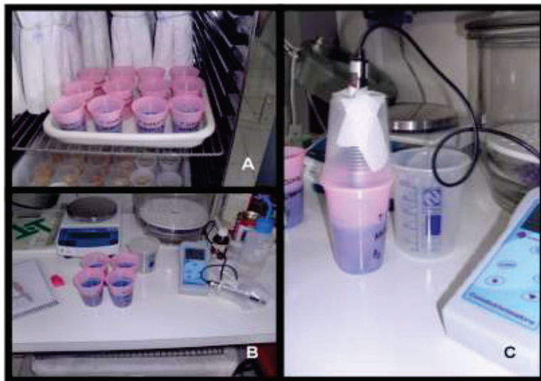
Figura 5. Teste de condutividade elétrica: A- Amostras em repouso a 25 °C em germinadores. B- Amostras prontas para leitura no condutivímetro. C- Condutivímetro realizando leitura em uma das repetições.
