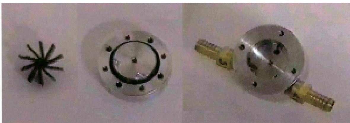
Figura 3.10 – Segundo protótipo de transdutor tipo turbina desenvolvido
