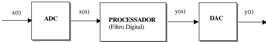
Figura 4.3 Diagrama simplificado de um filtro digital Fonte: Ifeachor e Jervis, 1995
