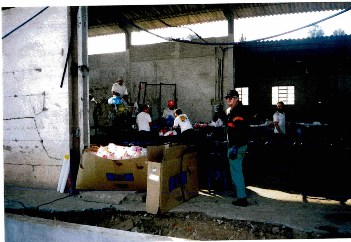
FOTO 8 - No mesmo local, há uma Usina de Triagem e Reciclagem na qual os resíduos provenientes da coleta seletiva são separados manualmente
