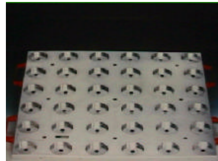
Placa óptica 5x5 para apalpadores ópticos, Placa de aço, Superfície negra de Ø 20mm Distâncias entre centros de círculos vizinhos nos eixos X e Y de 166 mm
