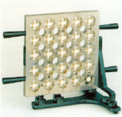
Placa de esferas 5x5 (tipo comercial), Placa de aço, Esferas de cerâmica, Distâncias entre centros de esferas vizinhas nos eixos X e Y de 83 mm
