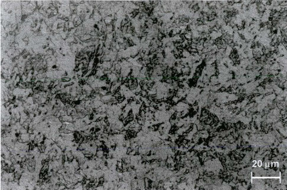
**FIGURA 4.20** – Microestrutura martensítica do metal depositado com arame tubular AWS E 410 Ni Mo T-2. Dureza: 346 HV. Ataque: Vilella.
