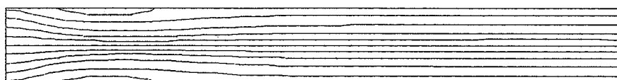
Fig 4.1-Escoamento simétrico em difusor radial com alimentação radial para Re=100 , com malha colocizada , obtido por Peters (1994)
