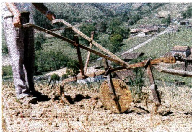
Figura 2.10: Escarificador com disco de corte. WEISS (1998)
