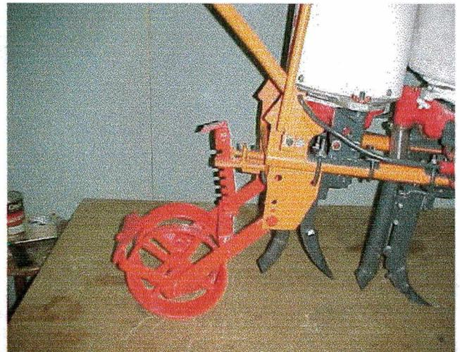
Figura 4.32: Detalhes do sistema de ajuste de profundidade dos cinzeis.
