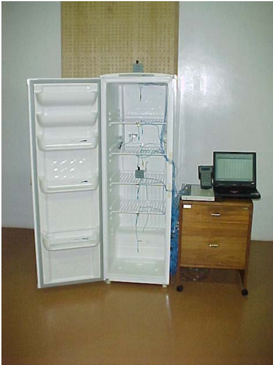
Figura 4.2 – Refrigerador e equipamento de medição
