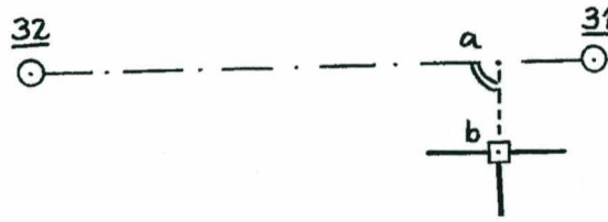
Figura: 3.39: Levantamento do ponto “b” com relação aos pontos de levantamento “32” e “31”.
