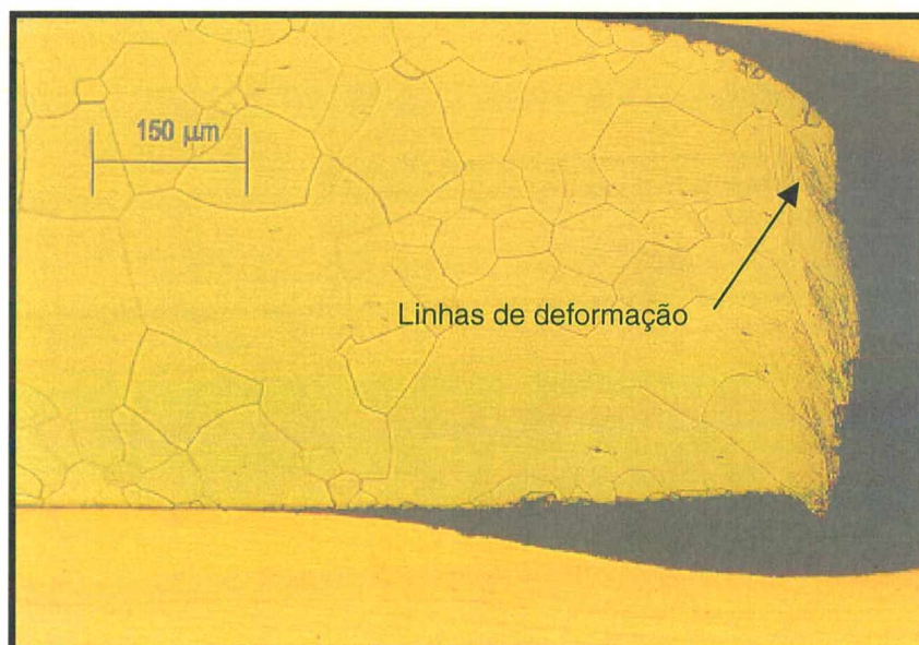
Figura 33 – Microestrutura da região do dente da ranhura Grupo 3 - Mebsa – Ataque Nital 2%
