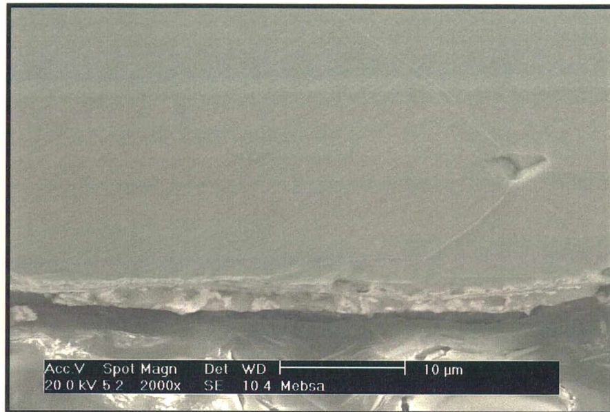
Figura 47 – Microestrutura da região da coroa - grupo 3 - Mebsa
