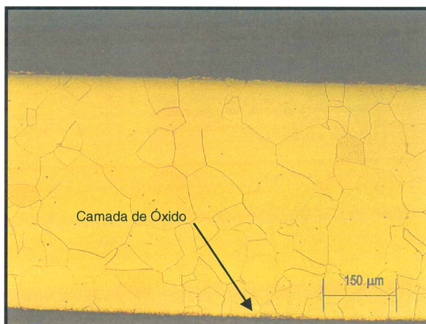
Figura 29 – Microestrutura da região da coroa Grupo 2 - Brasimet – Ataque Nital 2%
