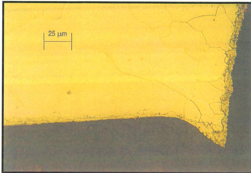
Figura 31 – Microestrutura da região do dente – parte inferior Grupo 2 - Brasimet – Ataque Nital 2%
