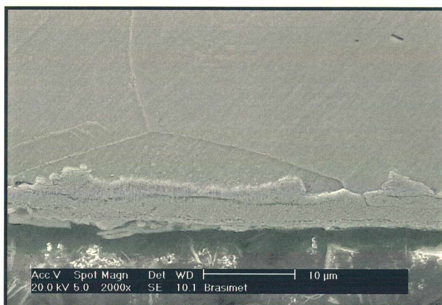
Figura 46 – Microestrutura da região da coroa - grupo 2 - Brasimet
