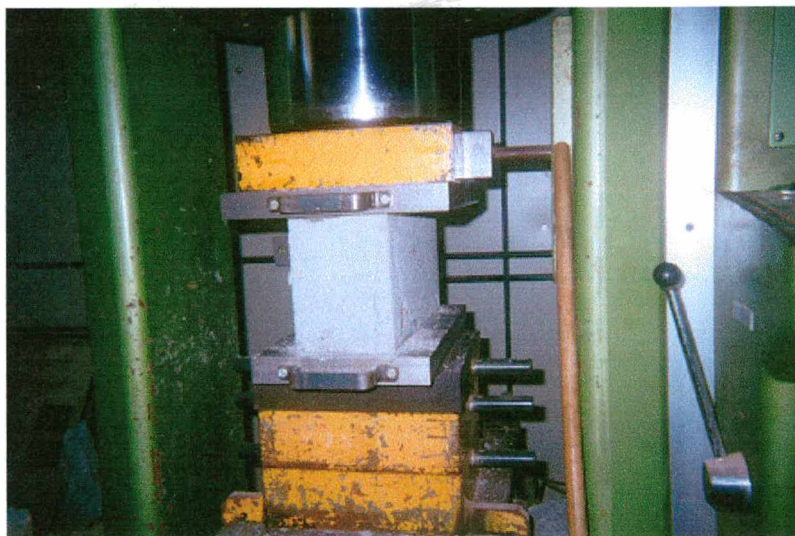
Figura 19 : Sistema utilizado no ensaio de compressão dos blocos de concreto. Prensa AMSLER (500tf) e pratos da prensa devidamente retificados com 38mm de espessura.
