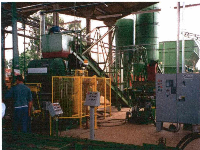
Figura 4: Fábrica de blocos de concreto. À frente do operador a máquina vibro-prensa e ao fundo os silos de cimento e agregados(balança)
