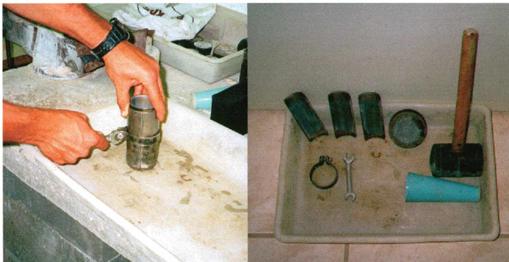
Figura 20 : Molde tripartido 5x13 utilizado para moldar os corpos-de-prova cilíndricos 5x10.
