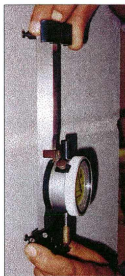
Figura 3.8 – Leitura das deformações nos prismas com extensômetro mecânico
