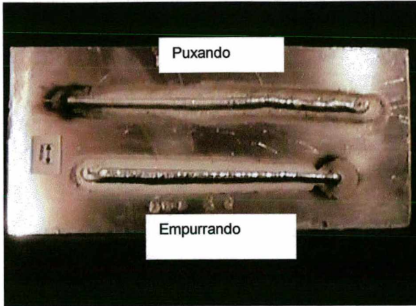
Fig. 28 Cordões de solda com corrente de pulso de 180 A
