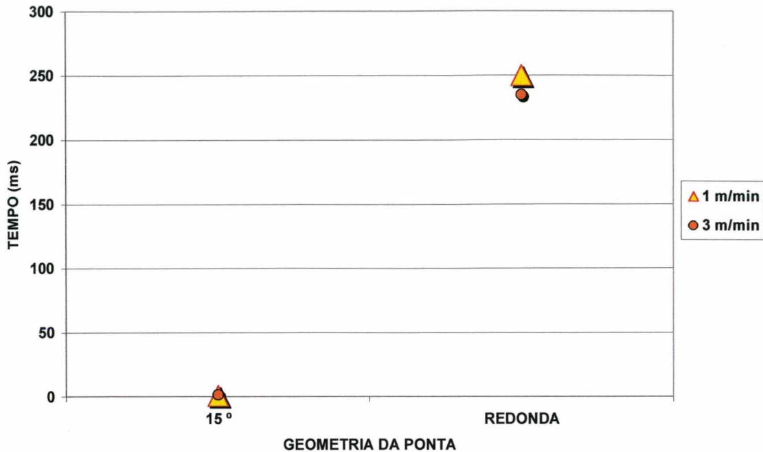
Fig. 20 Influência da velocidade de aproximação e da geometria da ponta do arame, sobre o tempo demandado até a abertura do arco ( t_{ab} ).
