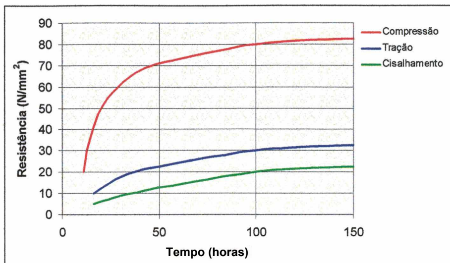
Figura 5.7 - Aumento de resistência do adesivo epoxídico (à temperatura de 15 °C)
