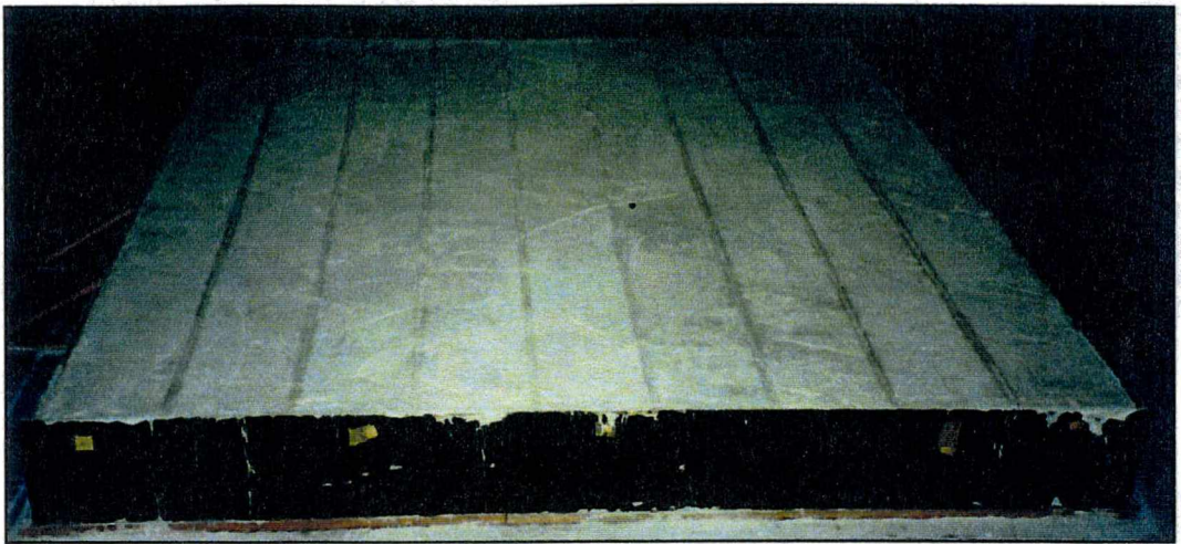
Figura 5.4 - Aspecto do concreto após a aplicação do agente de cura química (foco na parte inferior da foto)
