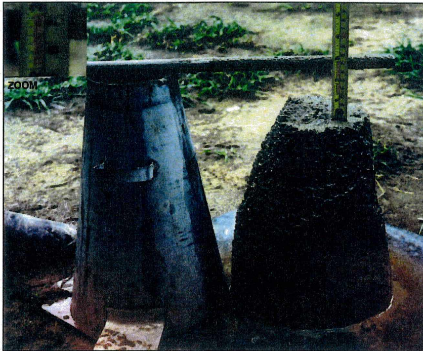
Figura 5.2 - Ensaio de abatimento do concreto ( Slump test )
