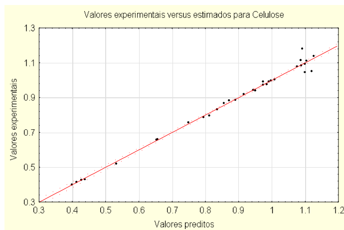
FIGURA 5.6 Valores preditos versus dados experimentais normalizados com a concentração inicial da madeira para celulose.
