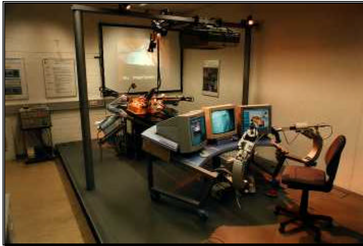
Figura 38 - Sistema experimental de telepresença para cirurgias minimamente invasivas
