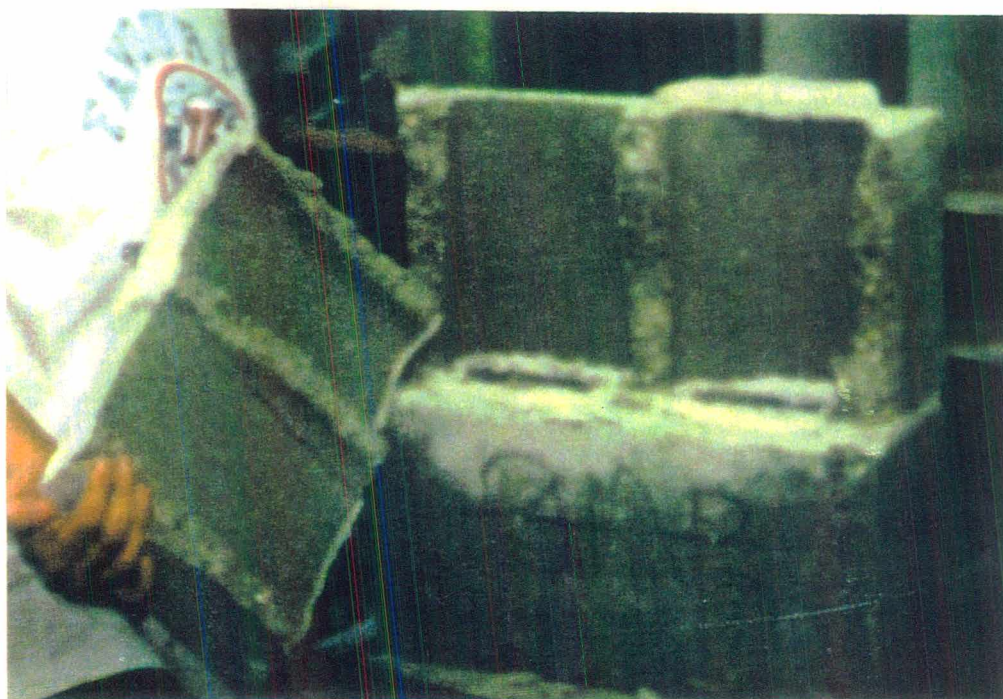
Figura 5.10 – Fissuração apresentada pela maioria dos prismas não grauteados
