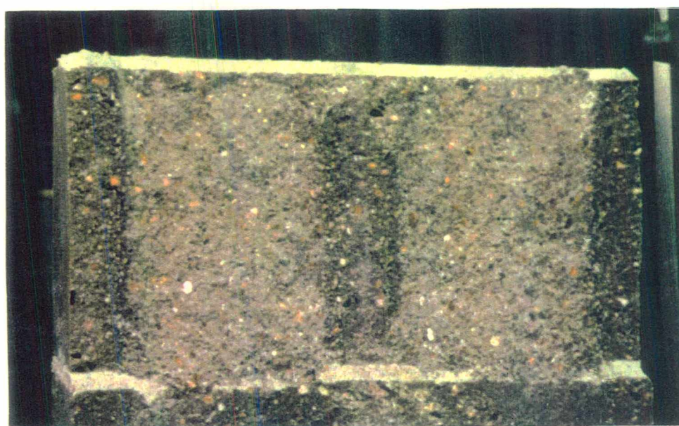
Figura 5.11 – Fissuração apresentada pela maioria dos prismas grauteados.
