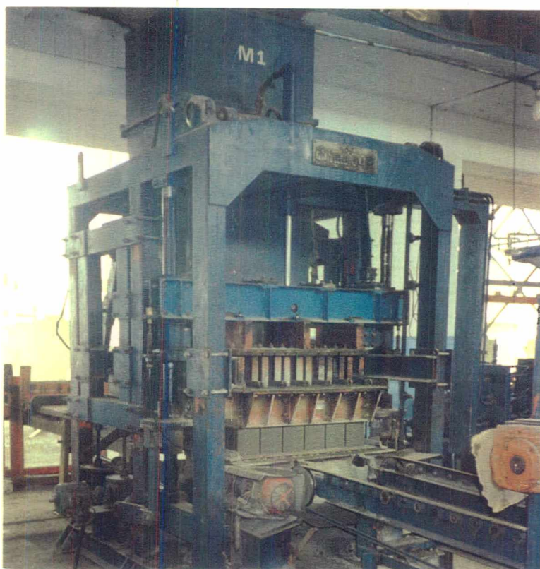
Figura 2.1 – Exemplo de vibro-prensa fixa utilizada na produção de blocos de concreto
