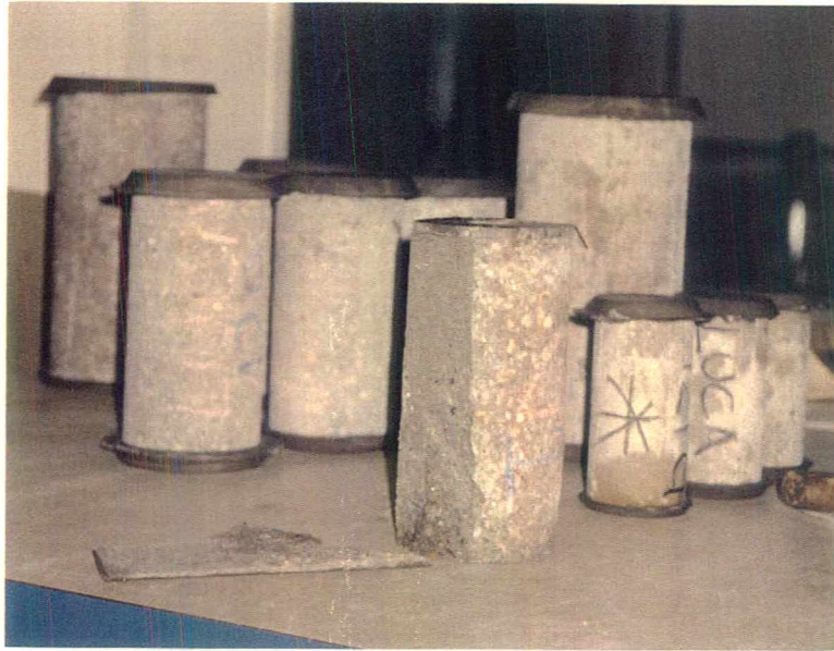
Figura 5.6 - Forma de ruptura de alguns corpos-de-prova de grautes extraídos
