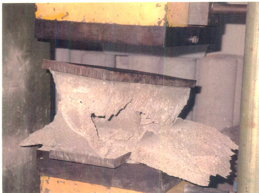
Figura 5.8 – Ruptura típica apresentada pelos blocos de concreto.
