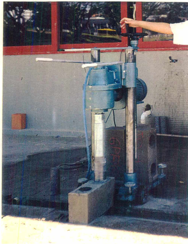
Figura 4.2 – Equipamento utilizado para a extração dos corpos-de-prova de graute
