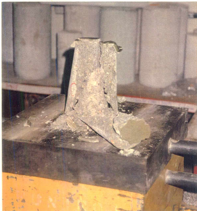
Figura 5.7 - Forma de ruptura dos corpos-de-prova de graute moldado em forma metálica.
