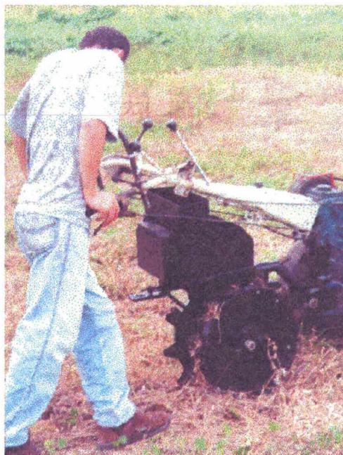
Figura 7.2 - Semeadora adubadora em operação, sem o sistema cobridor compactador
