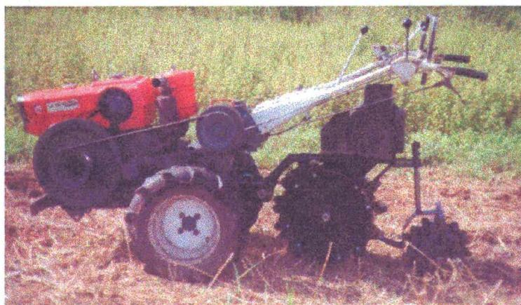
Figura 7.5 - Protótipo acoplado ao trator de rabiças
