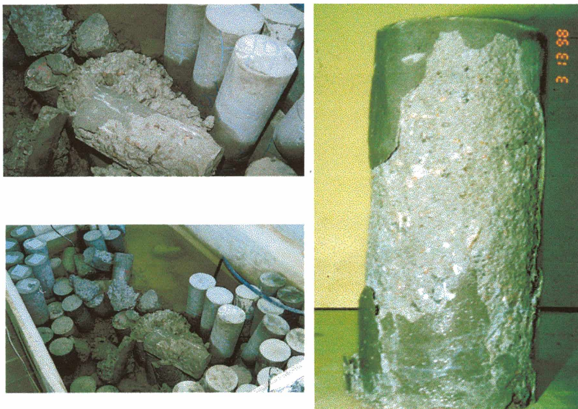
Figura 5-35 Estado final dos corpos-de-prova de concreto que apresentaram fissuração, lançamento e perda de massa
