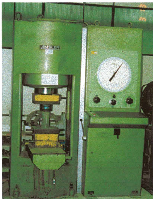
Figura 4-1 Prensa hidráulica utilizada para o ensaio de resistência à compressão axial de corpos-de-prova de concreto.
