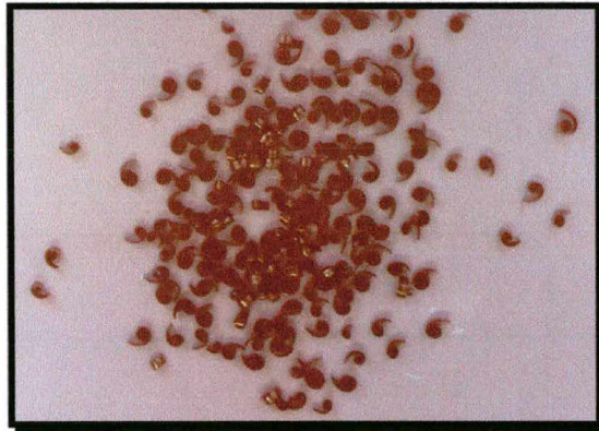
Figura 53 - Cavaco espiral curto, aço AISI 1040 Modificado [56]
