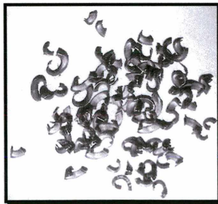
FIGURA 58 - Cavaco em arco conectado [56]
