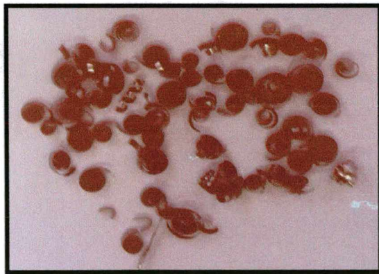
Figura 54 - Cavaco espiral cônico, aço AISI 1040 Modificado [56]
