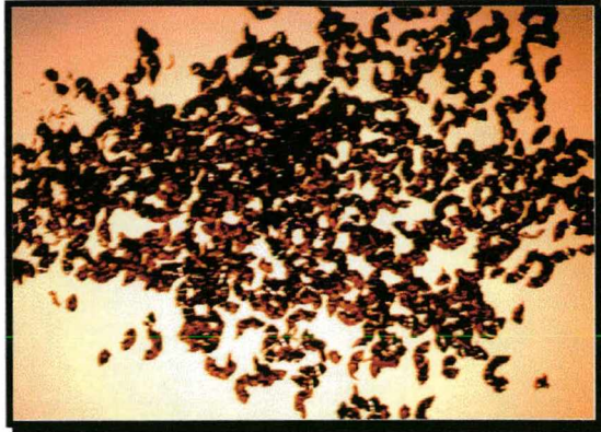
FIGURA 55 - Cavaco arco conectado, aço AISI 1040 Referência [56]
