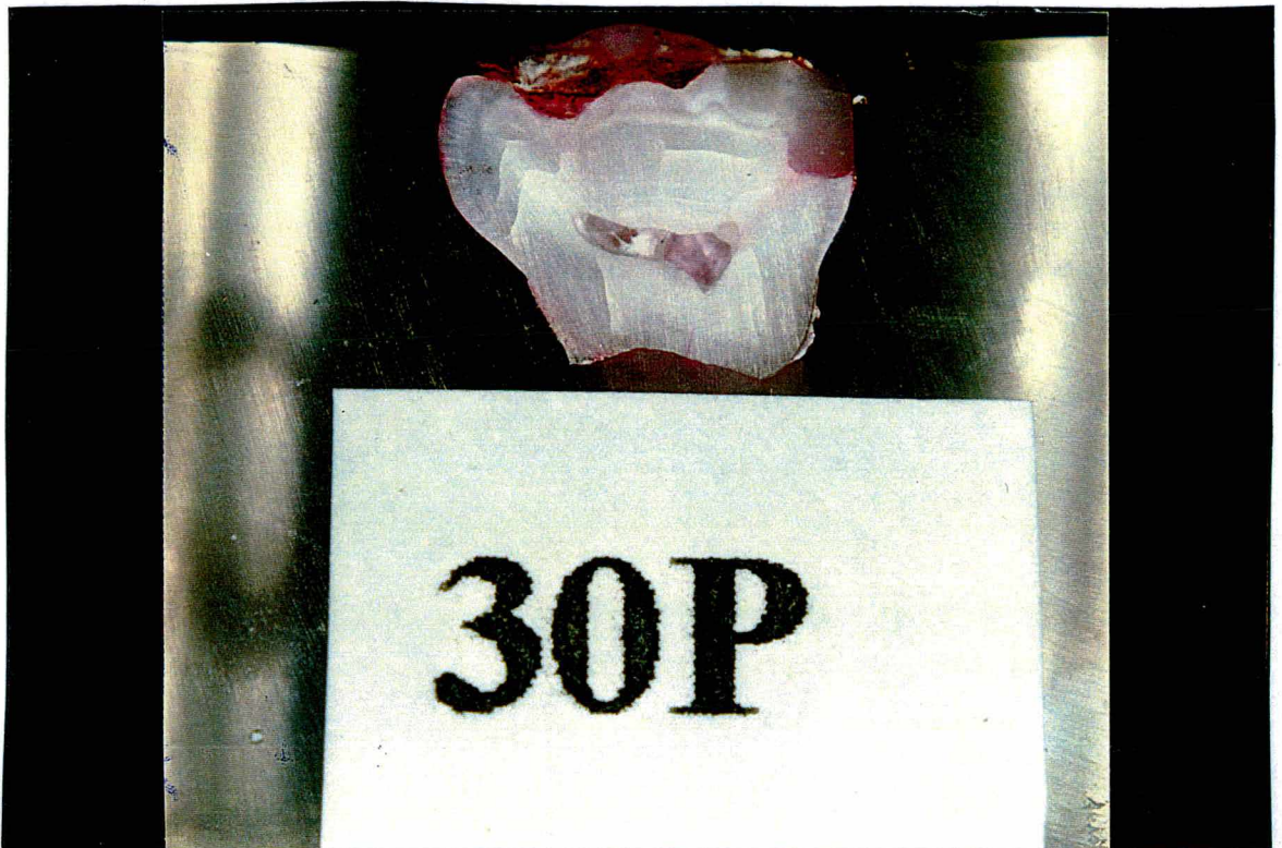
FIGURA 3 - Corpo de prova 30P: restauração realizada pela técnica de inserção única, com penetração do corante atingindo a junção amelo-dentinária (escore 2).
