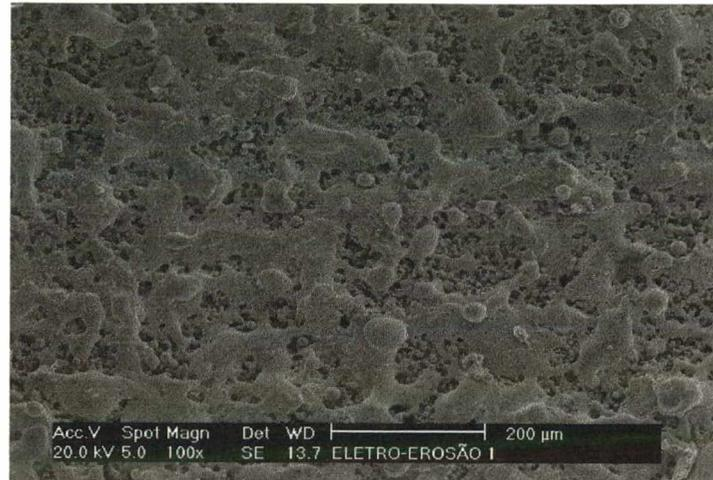
Figura 34 - Fechamento parcial dos poros causado por microfusão na superfície interna do material durante a eletroerosão (MEV).
