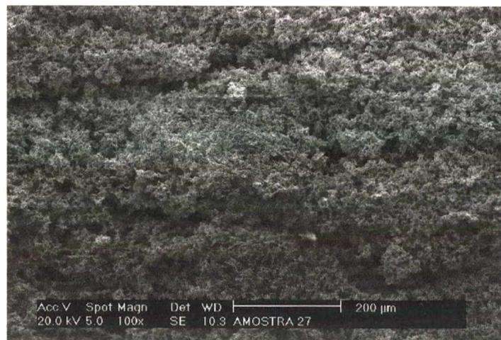
Figura 31 - Irregularidades provocadas na superfície externa das peças pelo ataque ácido (MEV).
