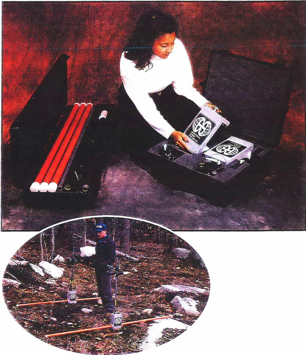
Figura 7.4 - A antena 3200MLF da GSSI. “MLF” é acrônimo de “Multiple Low Frequency”. Variando-se o comprimento da antena, modifica-se a frequência de operação. Esta antena pode ser usada pelo radar mostrado na Figura 7.3. Comprimento: 120 cm a 600 cm. Frequência central: 16 MHz a 80 MHz. Largura dos pulsos: 12 ns a 60 ns.
