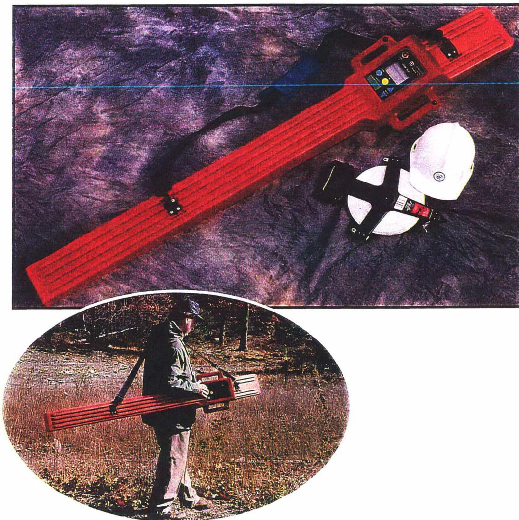
Figura 7.1 - O radar GEM-300, da Geophysical Survey Systems Inc. (GSSI). Freqüências de operação: 330 Hz a 20 kHz. Comprimento: 190 cm. Maior largura: 20 cm. Maior altura: 15 cm. Peso: 6,4 kg. Memória para 112000 medidas. Faixa de condutividade elétrica: 0,1 mS/m a 1 S/m. Espaçamento entre as espiras: 1,3 m. Baterias recarregáveis. Os resultados são disponíveis em forma de texto ou em forma gráfica.
