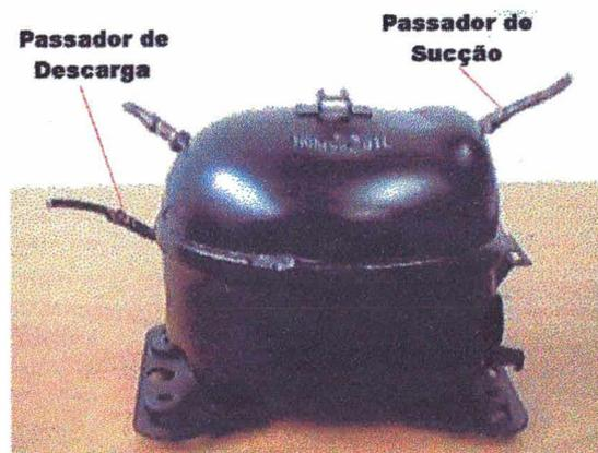
Figura 2.2 - Posicionamento dos transdutores de pressão e temperatura nos passadores de sucção e descarga
