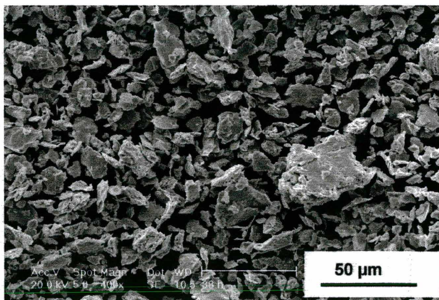
FIGURA 20 - Partículas de \text{Fe}_{75}\text{Si}_{10}\text{B}_{15} (amorfo 1) após 38 horas de moagem em moinho SPEX, com tolueno, 400X.
