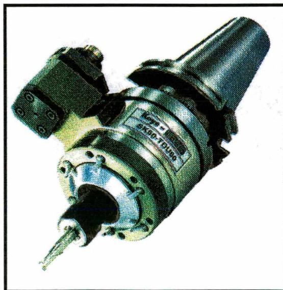
**Figura 18** - Cabeçote de alta velocidade [22].
