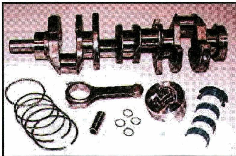
**Figura 41** - Mancais hidrodinâmicos de um motor de automóvel.
