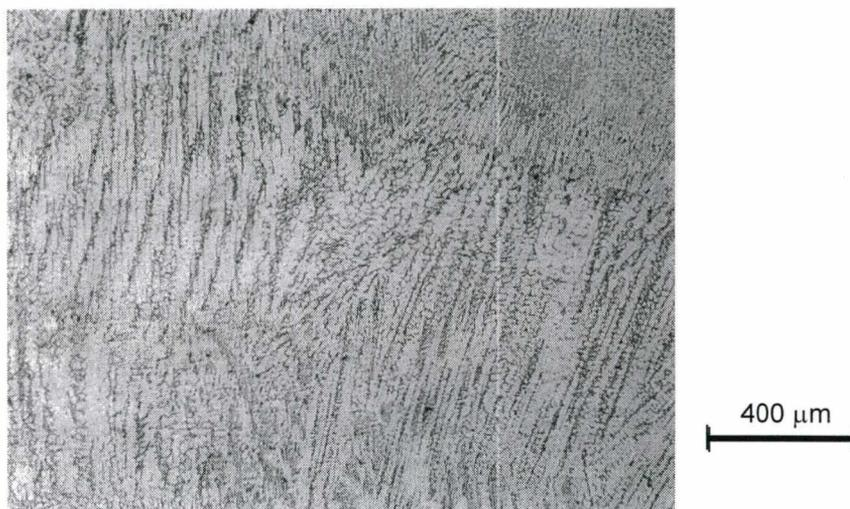
FIGURA 30 - Microestrutura do metal de solda obtido com eletrodo 309L-15 após refusão com TIG, apresentando matriz mista de austenita e ferrita delta. Ataque: Marble
