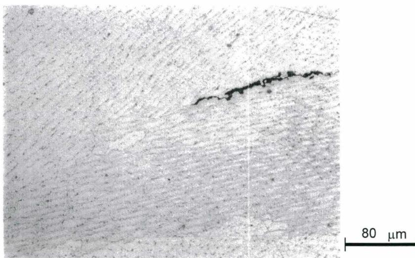
FIGURA 31 - Microestrutura do metal de solda obtido com eletrodo NiCrFe-2 após refusão com TIG. Matriz austenítica revelando ainda zonamento (*coring*) resultante do processo de solidificação bem como a propagação de trinca em contorno de grão. Ataque: Marble.
