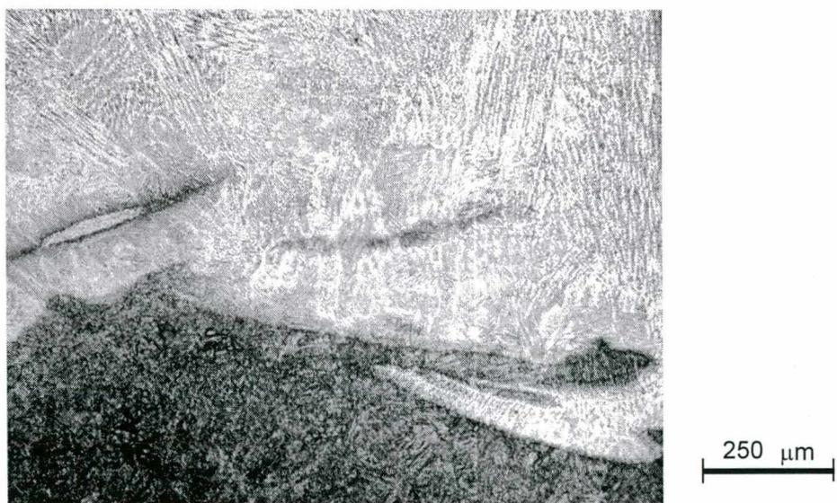
FIGURA 35 – Microestrutura junto à linha de fusão destacando a presença de zonas parcialmente diluídas sob forma de ilhas e penínsulas. Ataque: Marble.
