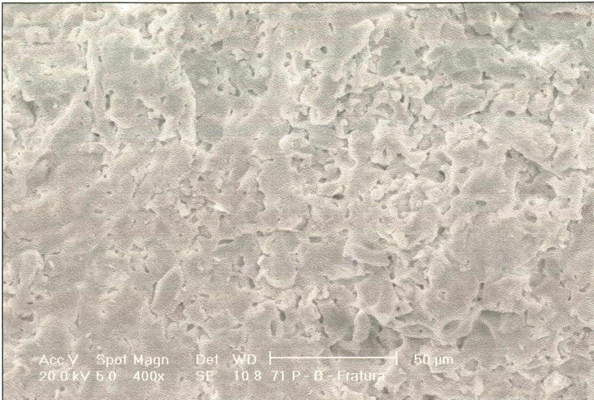
*Figura 4.7.1.6 - Região de fratura da amostra com 7 horas de moagem dos materiais plásticos e 1 hora de moagem dos materiais não-plásticos (pressão -  $350 \text{ kgf/cm}^2$ ) - aumento de 400x em microscópio eletrônico de varredura (MEV)*
