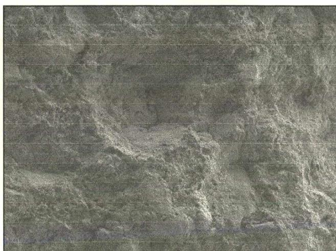
*Figura 2.7.9 - Detalhe da fratura do pavimento seco com aglomerados não destruídos - aumento de 110 x em microscópio eletrônico de varredura (MEV) – cortesia Eliane Revestimentos Cerâmicos.*
