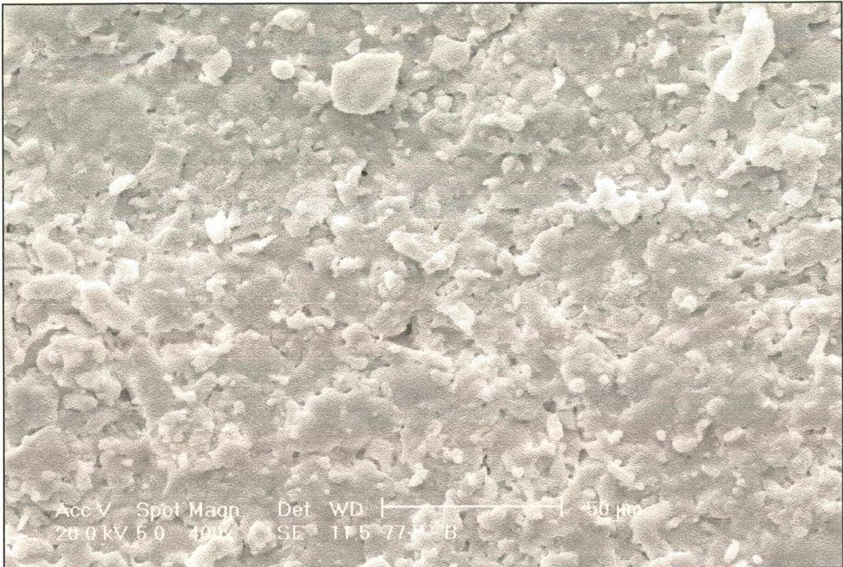
*Figura 4.7.1.7 - Região de superfície da amostra com 7 horas de moagem dos materiais plásticos e 7 horas de moagem dos materiais não-plásticos (pressão - 350 kgf/cm<sup>2</sup>) - aumento de 400x em microscópio eletrônico de varredura (MEV)*
