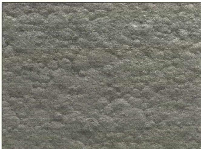
*Figura 2.7.5 - Superfície de pavimento seco - aumento de 40 x em microscópio eletrônico de varredura (MEV) – cortesia Eliane Revestimentos Cerâmicos.*
