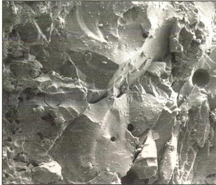
*Figura 2.7.11 - Detalhe da região esmaltada - aumento de 320 x em microscópio eletrônico de varredura (MEV) – cortesia Eliane Revestimentos Cerâmicos.*
