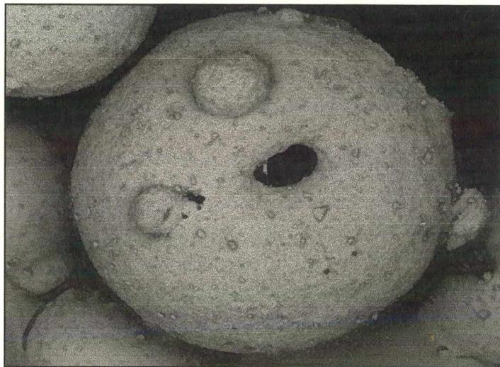
*Figura 2.7.4 – Pó cerâmico atomizado - aumento de 250 x em microscópio eletrônico de varredura (MEV) – cortesia Eliane Revestimentos Cerâmicos.*
