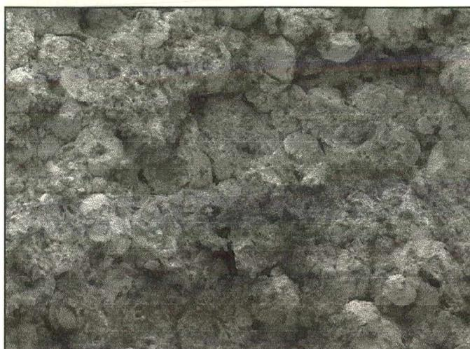
*Figura 2.7.8 - Detalhe da fratura do pavimento seco com aglomerados não destruídos - aumento de 40 x em microscópio eletrônico de varredura (MEV) – cortesia Eliane Revestimentos Cerâmicos.*
