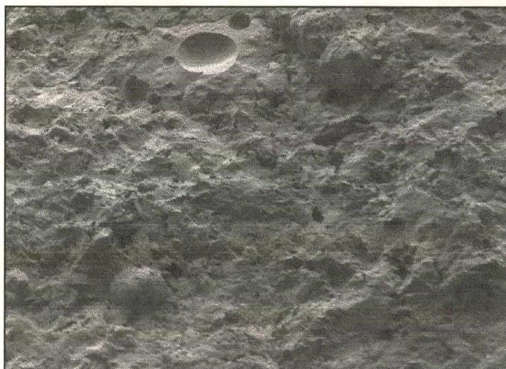
*Figura 2.7.13 - Detalhe da região fraturada do pavimento sinterizado - aumento de 160 x em microscópio eletrônico de varredura (MEV) – cortesia Eliane Revestimentos Cerâmicos.*
