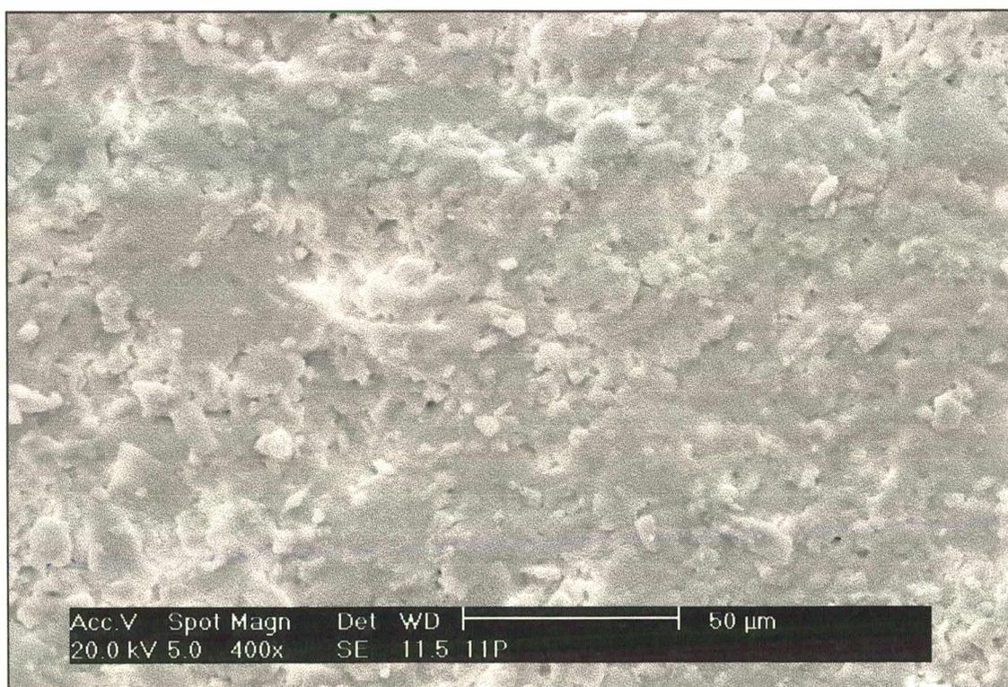
Figura 4.7.1.1 - Região de superfície da amostra com 1 hora de moagem dos materiais plásticos e 1 hora de moagem dos materiais não-plásticos (pressão -  $350 \text{ kgf/cm}^2$ ) - aumento de 400x em microscópio eletrônico de varredura (MEV)
